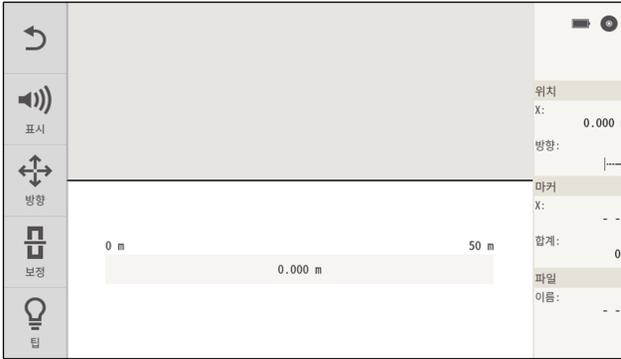
이 기능을 이용해 콘크리트 구조물의 긴 측정 구간을 기록할 수 있습니다. 스캔 방향과 직각으로 놓인 보강철근은 스캔 종료 후 평면도 및 단면도로 표시할 수 있습니다.
