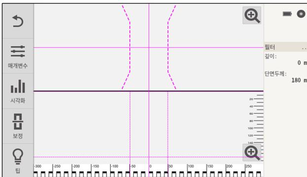
이 기능을 이용해 콘크리트 및 다른 비페라이트계 건축용 자재에서 보강철근의 위치를 확인하고 실시간으로 표시할 수 있습니다. 스캔방향에 직각으로 놓인 보강철근은 평면도 및 단면도로 표시되며, 표시 홈을 통해 직접 분석하는 면적에 표시할 수 있습니다.
