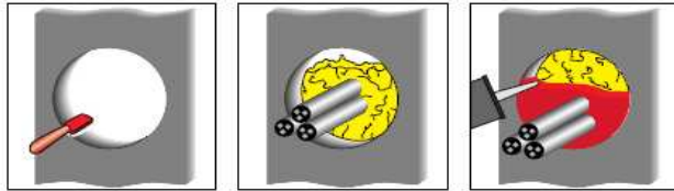
개구부 청소 암면충진(필요시) FS-One 시공
