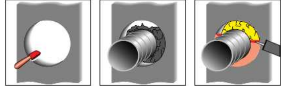
개구부 청소 암면충진(필요시) FS-One 시공
