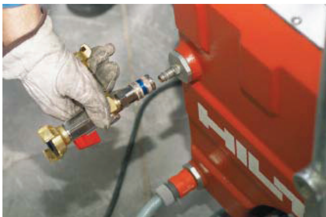
Montáž rozdělovače vody.
