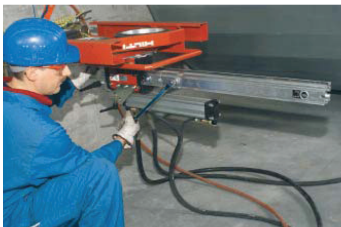
Nasad'te sestavu rozšiřující zásobu lana a zajištěte excentrickými čepy.
