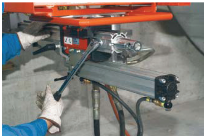
Zasuňte spojovací kužel a sevřete excentrickým čepem.
