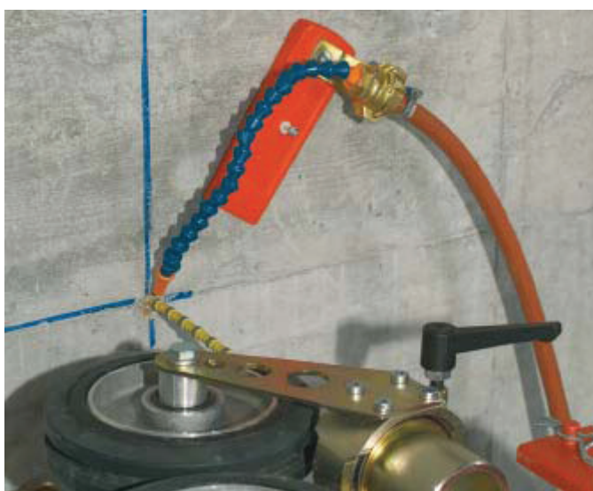
Montér mundstykket (til det kølende vand)
